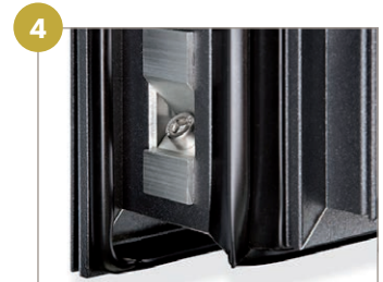
4 STABILE ECKVERBINDUNGEN Profile auf Gehrung verschraubt, verklebt und verbolzt
